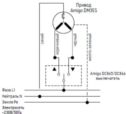
**Внимание! Не допускается параллельное подключение двух и более приводов**
